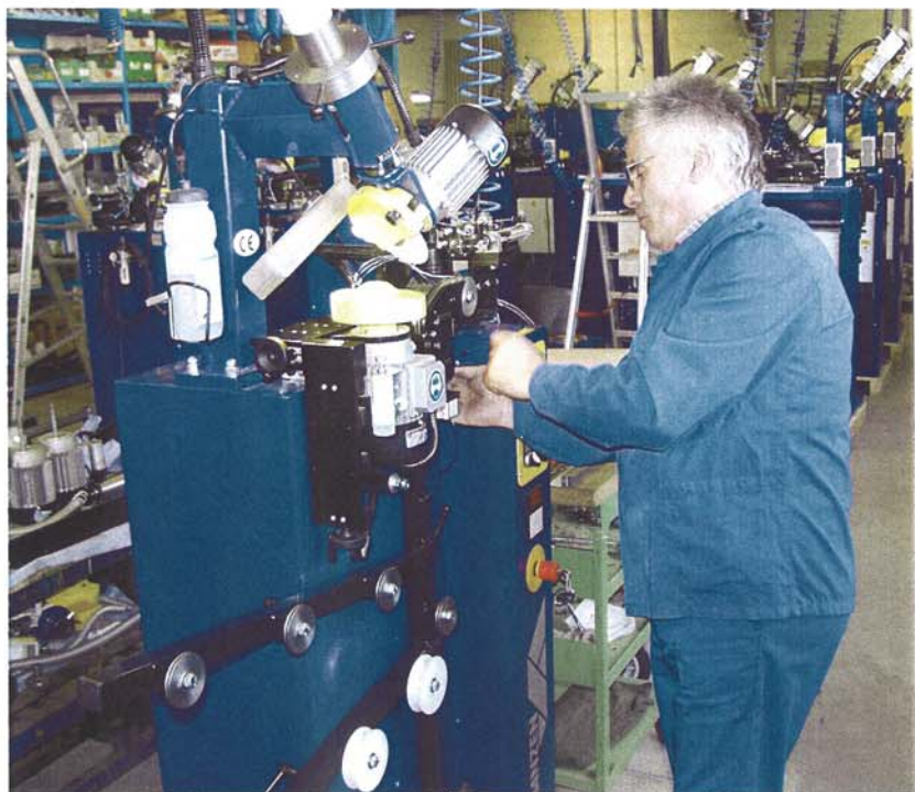
Heinz Kitz nimmt letzte Einstellarbeiten an einem Kettenschärfautomaten vor.
